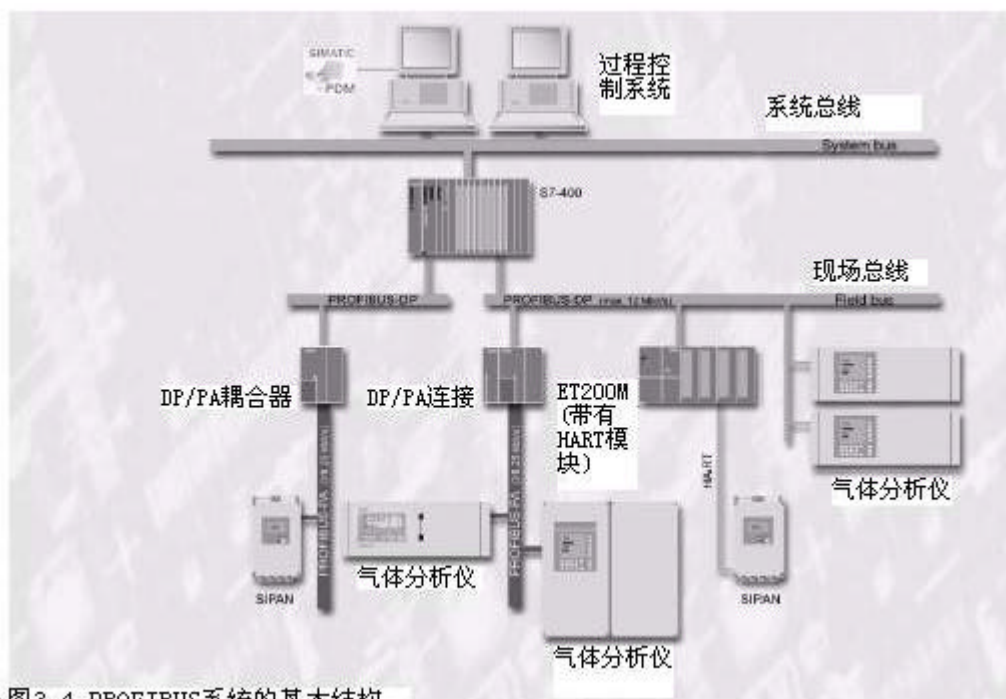
图3-4 PROFIBUS系统的基本结构
